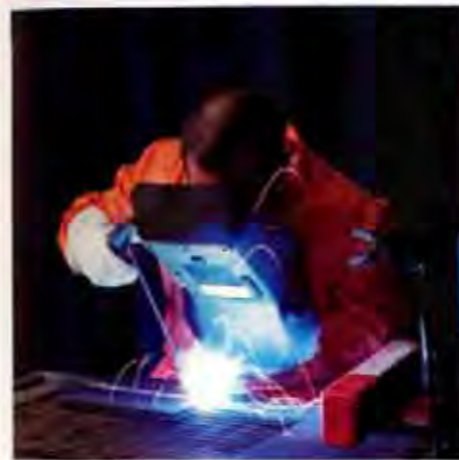
4 Die Kunst des Gasschweißens – Oberkopfschweißen mit dem Schweißbrenner Starlet
