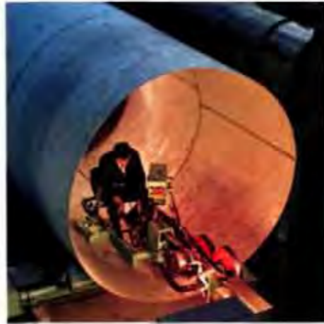
1 und 5 Der UP-Schweißautomat E 18 ist nach dem Baukastensystem konstruiert. Durch Ergänzen bzw. Umrüsten kann er anderen Schweißaufgaben angepaßt werden
