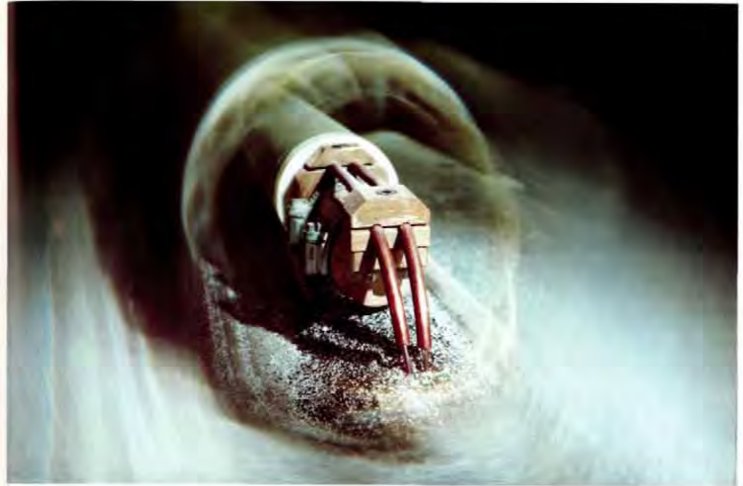
1 und 5 Der UP-Schweißautomat E 18 ist nach dem Baukastensystem konstruiert. Durch Ergänzen bzw. Umrüsten kann er anderen Schweißaufgaben angepaßt werden
