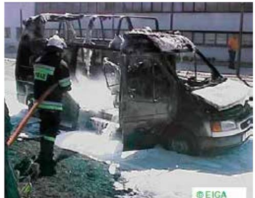
Eine undichte Acetylenflasche hat sich in einem Lieferwagen am Flaschenventil entzündet. Der Fahrer konnte gerade noch entkommen. Das Fahrzeug brannte in nur zwei Minuten aus.
