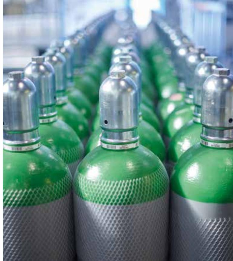
Diese 300 bar - Bündel sind mit einer integrierten Druckreduzierung auf 200 bar ausgestattet und können dadurch ohne weitere Massnahmen an die vorhandenen 200 bar - Installationen angeschlossen werden.
