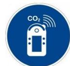
**Ein häufiger Fehler besteht darin, dass nur der Sauerstoffgehalt und nicht die Kohlendioxid-Konzentration gemessen wird. Ein solcher Fehler kann bei CO<sub>2</sub> tödlich enden.**
