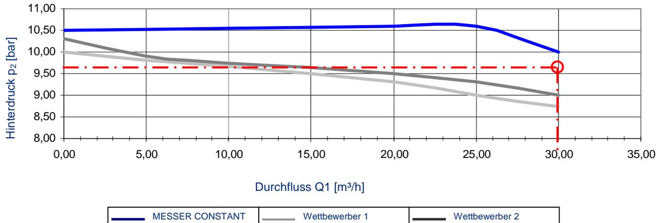
Um die Geräteklasse 3 der DIN EN ISO 2503 zu erfüllen, muss der Flaschendruckregler bei einem Vordruck p<sub>1</sub> von 21 bar und einem Hinterdruck p<sub>2</sub> von 10 bar einen Nenngasdurchfluss Q<sub>1</sub> von 30 m<sup>3</sup>/h erreichen.
