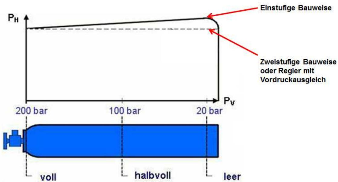
Die Abhängigkeit zwischen Eingangsdruck und Ausgangsdruck führt bei einstufigen Druckreglern bei zunehmender Entleerung der Flasche zu einem leichten Anstieg des Ausgangsdrucks. Dies kann ggf. eine Nachregulierung des Arbeitsdrucks erforderlich machen.
