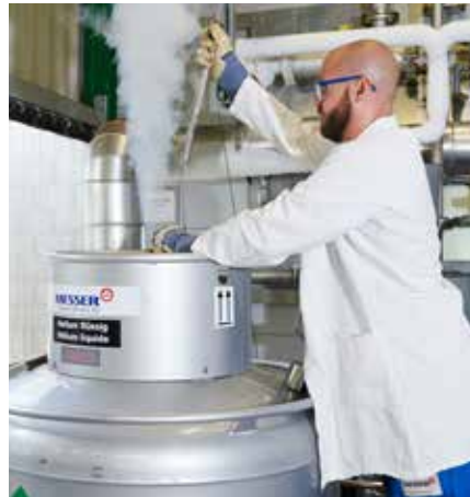
Für die Versorgung mit Helium stehen je nach Mengenbedarf Dewars in Größen zwischen 50 und 450 Litern zur Verfügung.
